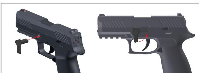
9. Reempuje la palanca de desmontaje en el orificio previsto y devuélvala a su posición original girándola en sentido horario.
