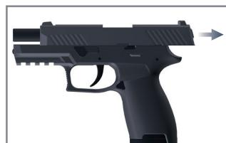
4. Ziehen Sie den Schlitten bis zum Ende zurück und lassen ihn los. So wird die erste Patrone geladen.
