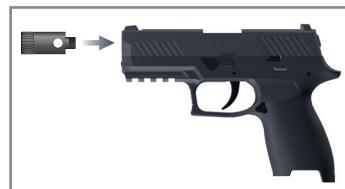
1. Atornille el extensor de cañón (adaptador de disparo) en la boca del arma no cargada.
