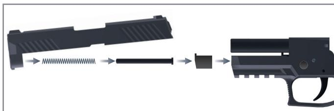
6. Setzen Sie Schlitten, Hülse, Feder und Federführungsstange in der abgebildeten Reihenfolge zusammen und schieben den Schlitten von vorn auf die Waffe.
