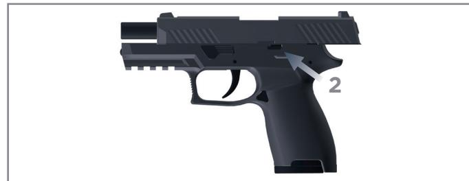
**Nota:** Después del último disparo (siempre que el cargador esté vacío), la corredera permanece en la posición trasera.
