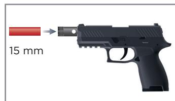
3. Introduzca la munición de señalización en el extensor de cañón (adaptador de disparo), con el extremo abierto primero.
