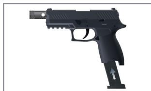
2. Inserte un cargador alimentado en el arma.
