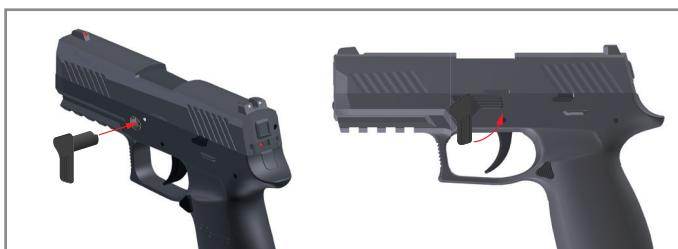
9. Repousser le levier de démontage dans le trou prévu et ramenez-le dans la position d'origine en le tournant dans le sens horaire.
