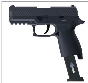
3. Inserte el cargador cargado y compruebe que esté completamente enclavado.
