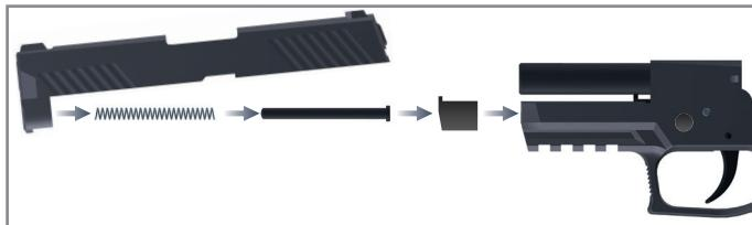
6. Réassemblez la culasse, la douille de guidage, le ressort et la tige de guidage du ressort en suivant les étapes illustrées dans la figure, puis faites glisser la culasse sur l'arme par l'avant de l'arme.
