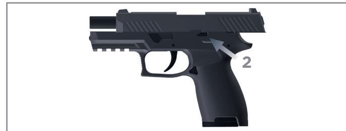
**NOTE :** Après le dernier tir (lorsque le chargeur est vide), la culasse reste en position arrière
